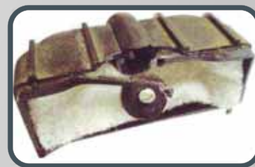
Рис 1. Механическое повреждение всасывающего фильтра
